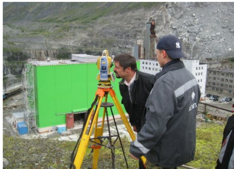
Роботизированный тахеометр Imaging Station фирмы «Торсон» в условиях горного предприятия ОАО «Апатит»
